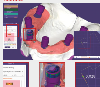
Nicht perfekt. Best fit mit falscher Toleranz
