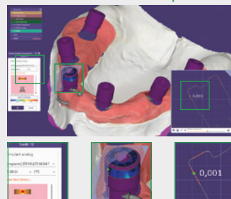
OK. Best-fit con tolerancia óptima
